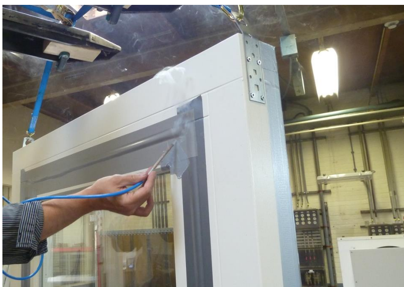
Foto 2 De testkast is afgeplakt. Met behulp van rook zijn resterende luchtlekken verholpen. Hier is het draaiend deel afgeplakt ten behoeve van de nulmeting van de testkast.
